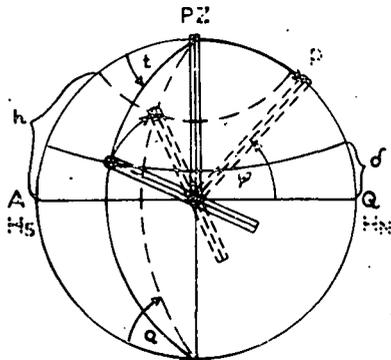
Abb. 2. Prinzip von „Navicard“. Die Bestimmung der Höhe der Sonne über dem Horizont und des Azimuts der Sonne mit einer Deklination von  $20^\circ$  und einem Stundenwinkel von  $30^\circ$ . — Bezeichnungen wie im Abb. 1.
