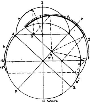
Abb. 4. Entwurf des orthographischen Projizierens auf die Meridianebene zur Feststellung von der Höhe und dem Azimut der Sonne, dem Zeitpunkt und dem Ort des Sonnenaufganges und Unterganges, sowie der Dämmerungsdauer ohne der Verwendung von ausführlichen Zeichnungen des Koordinatennetzes. —  $t_0$  = der Stundenwinkel des Sonnenaufganges, bzw. des Unterganges,  $t_D$  = der Stundenwinkel des Anfangs bzw. des Endes von astronomischer Dämmerung. Weitere Bezeichnungen wie in vorigen Abbildungen.
