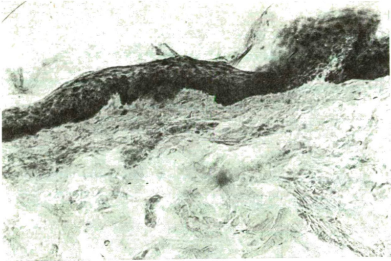
5. ábra. 59°C-on 5'-ig mavebit 1,5 %-os oldat + 1,5 % hypo oldattal kezelt bőr szöveti szerkezete (300×nagyítás)
