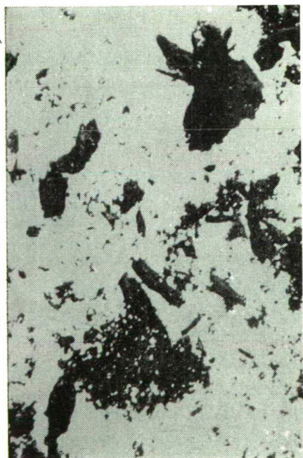
Fig. 4. Mikrophotographie der Esterkristalle |III|
