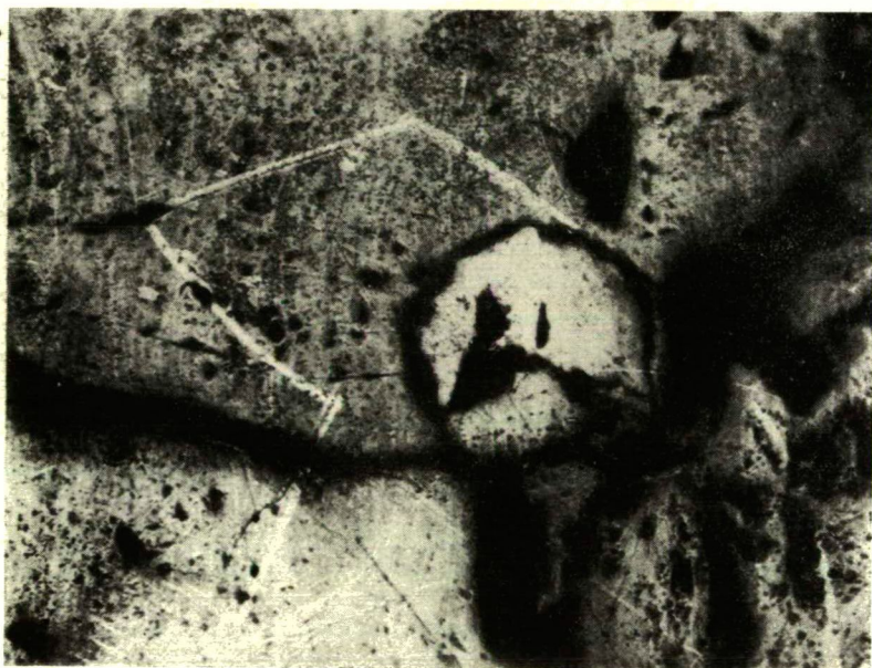
Fig. 2. Pyrit, nach der Behandlung \times 150
