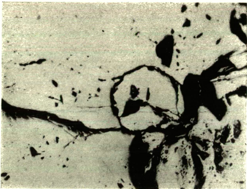
Fig. 1. Pyrit, ohne Behandlung \times 150
