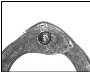
5. ábra: Rekonstruált huzalszegecses gyűrű szegecsfeje
