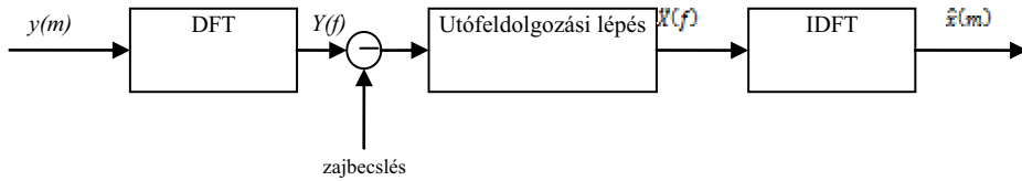
3. ábra. A spectral subtraction eljárás blokkdiagramja.
