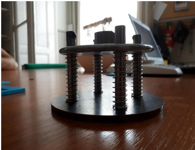
2. ábra: A rugós platform
