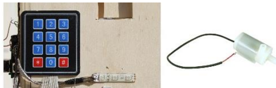
5. ábra: A locsolást végző szivattyú; a ház oldalán elhelyezett numerikus billentyűzet
