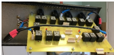
6. ábra. Bemeneti előerősítő, relés útválasztó
