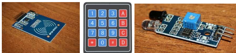
3. ábra: Az RFID olvasó, a billentyűzet, és az infra szenzor
