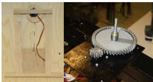
2. ábra: Az ajtónyitó mechanika és az áttétel
