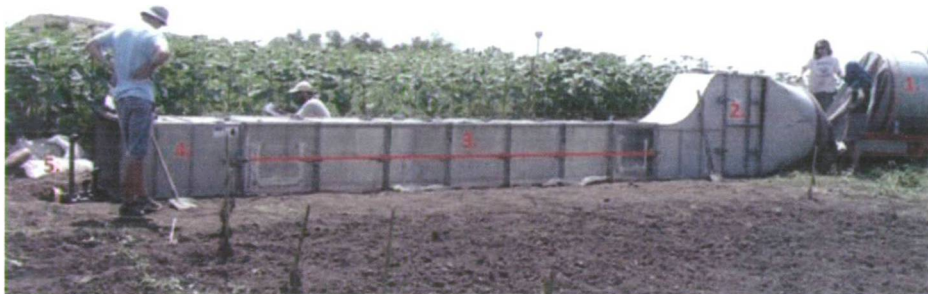
2. ábra. Szélcsatorna (részei: 1. turbina, 2. laminátor, 3. szélcsatorna elemek, 4. szediment tálca, 5. szélcsatorna kimeneti nyílása, csapdázók területe)
