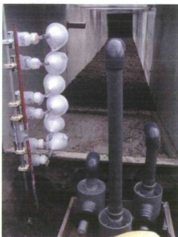
3. ábra. Bal oldalt az MWAC csapdák, jobb oldalt a WAST csapdák láthatók fújítás előtt
