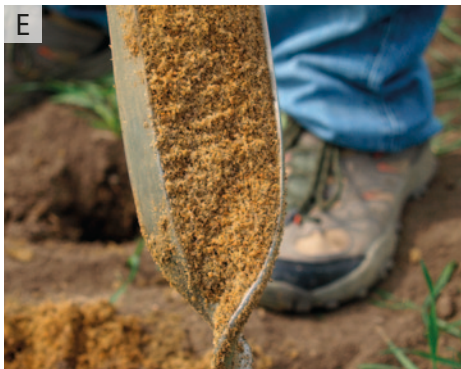
5. ábra: (A, B, C, D) Fúrás és mintagyűjtés szemcseösszetételi vizsgálatokhoz. (E) A homokos üledék sok esetben jól jelzi az egykori medertalpat. (F) A mérésekhez használt műszer.
