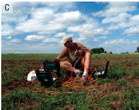
4. ábra: Georadaros és geoelektromos felmérések a különböző mintaterületeken (A, B, E – Orosháza, C, D – Kövegy, F – Nagyszentmiklós).
