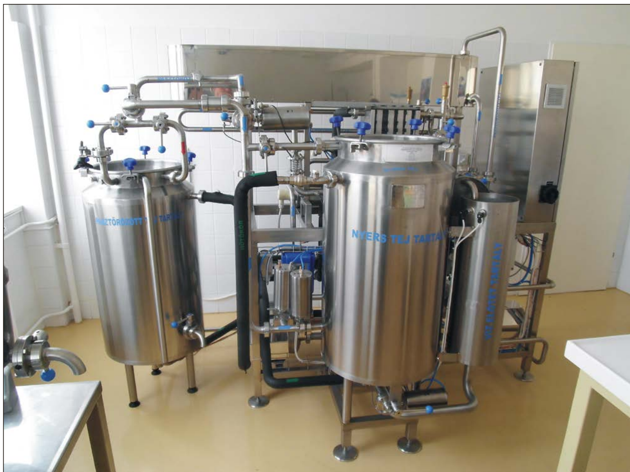
3. ábra. PG 015 Lemezes pasztöröző berendezés az Állatorvostudományi Egyetemen Figure 3 PG 015 plate pasteurization equipment at the University of Veterinary Medicine
