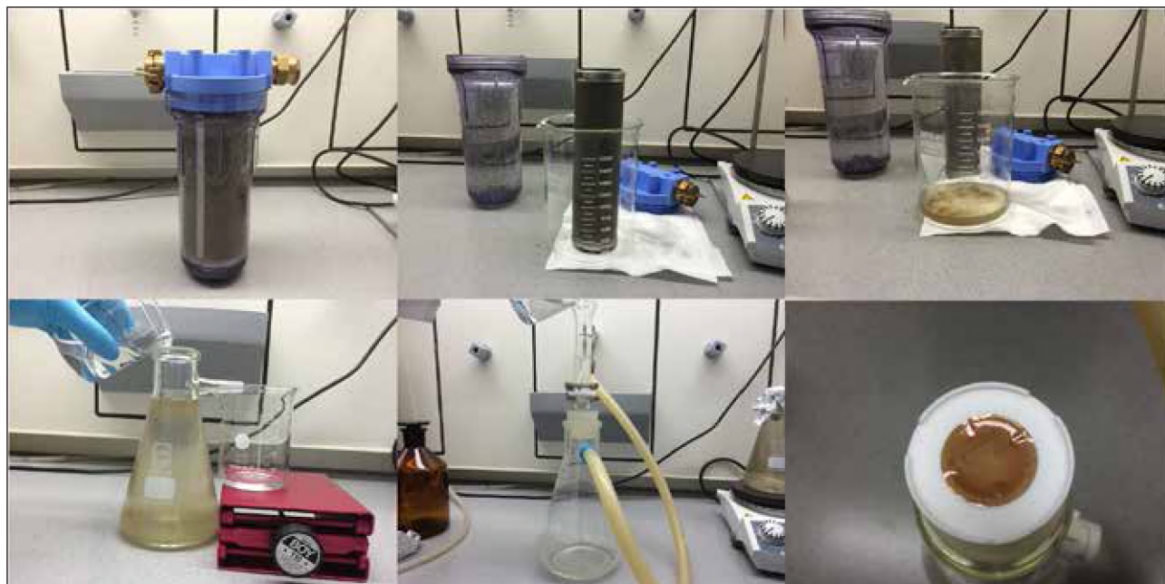
5. ábra: Vízminták előkészítése: kémiai kezelés, elválasztás és szűrés. Figure 5: Sample preparation of water samples, including chemical treatment, density separation and filtration.
