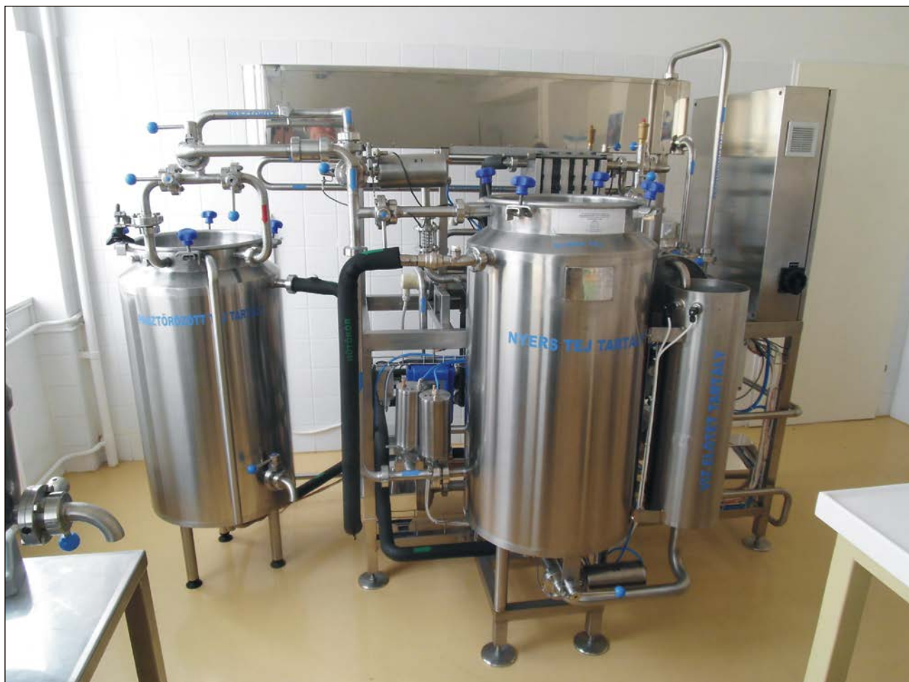
3. ábra. PG 015 Lemezes pasztőröző berendezés az Állatorvostudományi Egyetemen Figure 3 PG 015 plate pasteurization equipment at the University of Veterinary Medicine
