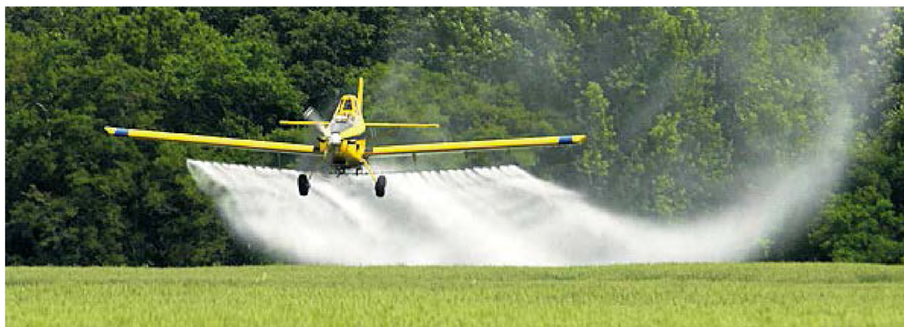
3. ábra. A tábla végén a szermaradék-koncentráció a permetező repülőgép felemelkedése következtében megnő. Ha a gépet a pilóta korábban emeli fel, akkor a tábla végére nem jut permetlé. (Forrás: Ganzelmeir)
