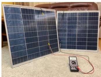
2. ábra: A két, új napelem panel első tesztelése mesterséges fény alatt
