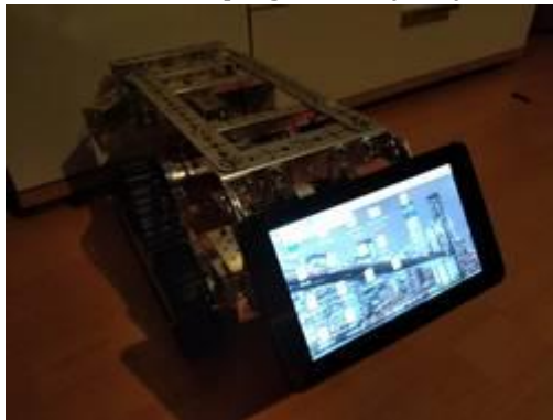
2. ábra: A robot kezelőfelületének érintőképernyője
