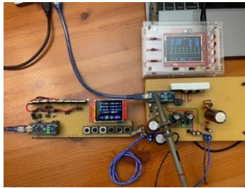
1. ábra: LCD kijelző és kimenetek (balra), MPPT töltésvezérlő (jobbra) vizsgálata oszcilloszkóppal
